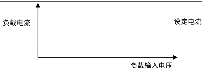
图 3-4 恒流模式示意图
