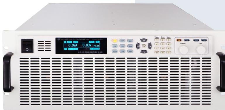
DH27800E 系列大功率可编程直流电子负载，功率密度可达 4U/6kW，可提供 150V、600V、1200V 三种电压等级，满足用户多种测试需求；具有 CC、CV、CP、CR 四种工作模式，并且具备动态和列表等测试功能。过压、过流、过功率、过温、反接等多种保护功能为用户安全使用提供保障；标配 LAN 和 USB 通信接口，方便用户通过远程控制。
